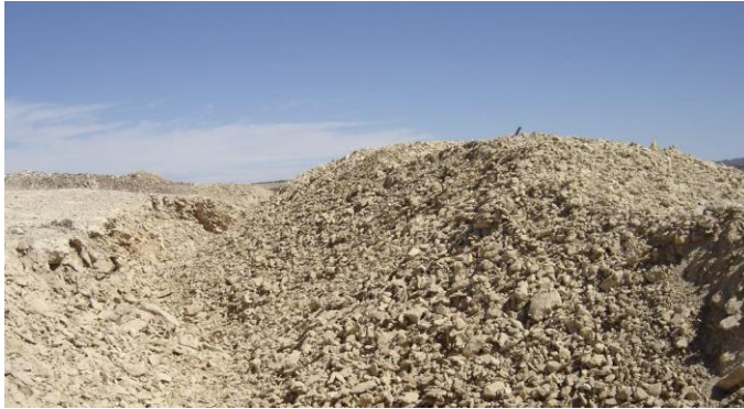
Ilustración 7: voladura con fragmentación homogénea, buen despegue de la pared y pila del material quebrado
