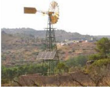
Molino de viento para extracción de agua.
