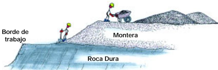
La montera debe ser retirada y trasladada a una distancia segura del borde de trabajo.
