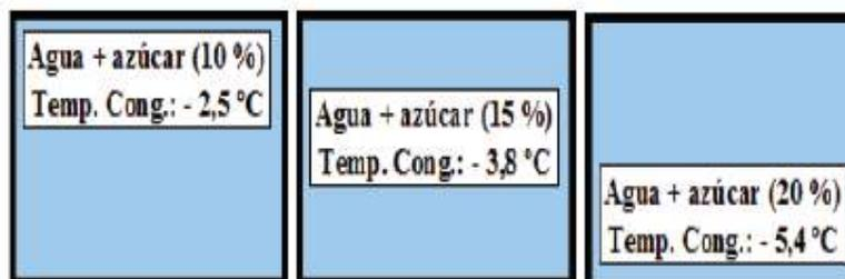
Figura 2: Descenso crioscópico en una solución de azúcar
