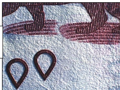
Microletras, gotas y parte inferior del Yaguareté del Billete de $ 500 en Impresión Calcográfica
