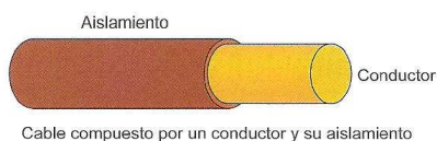
Figura 2.2. Concepto de cable y conductor.
