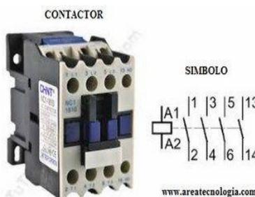
**\_Los contactos del circuito de salida o de fuerza se llaman 1-2, 3-4, etc.****\_Los contactos auxiliares, para el circuito de mando o control, suelen llamarse con número de 2 cifras, por ejemplo 13-14.**
