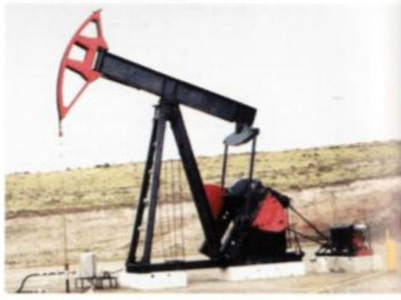
*El bombeo mecánico para la extracción de petróleo es el método más utilizado en Argentina*
