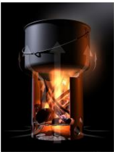
Las corrientes de convección se forman tanto en el agua de la olla como en el aire que rodea al fuego
