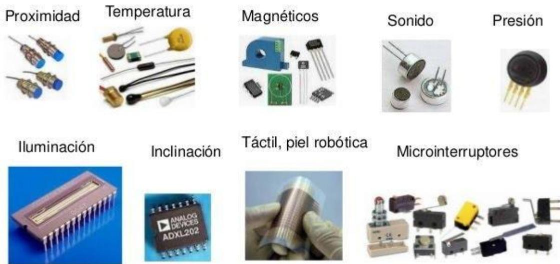
Un sensor o captador, como prefiera llamársele, no es más que un dispositivo diseñado para recibir información de una magnitud del exterior y transformarla en otra magnitud, normalmente eléctrica, que seamos capaces de cuantificar y manipular.
