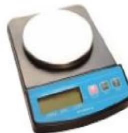
Balanza electrónica de alta precisión.
