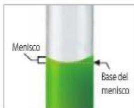
Cuando se mide el volumen en un tubo angosto, en la superficie del líquido se observa una curva llamada menisco.
