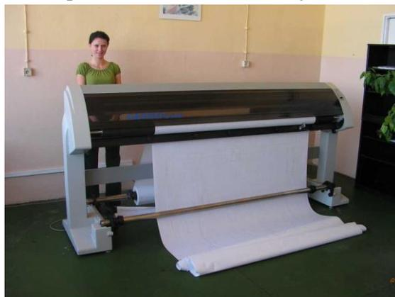
En la actualidad los plotters de inyección son los más usados, ya que realizan dibujos no lineales con mayor precisión y resultan más rápidos y silenciosos. Los plotters más antiguos, en cambio, se limitaban a realizar dibujos lineales.
