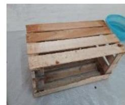
PARA PODER CLAVAR LAS MADERAS DE LA CUBIERTA SIN QUE SE ROMPAN DEBEMOS MOJAR POR UNOS SEGUNDO LOS DOS EXTREMOS. DISTRIBUIR LAS MADERAS SOBRE UN CAJÓN Y CLAVAR. MARCAR LAS MADERAS QUE SOBRESALEN DE LA CUBIERTA Y CORTAR CON EL SERRUCHO.
