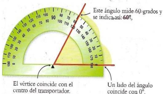
El transportador es un instrumento que permite medir y construir ángulos. Generalmente tiene forma de semicírculo y está dividido en 180 partes iguales; cada una de las partes representa un (1°)
