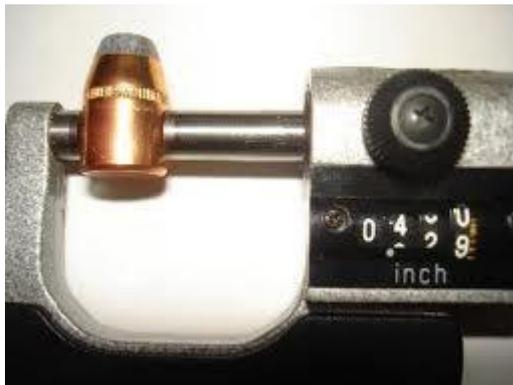
Instrumento de medición del calibre
