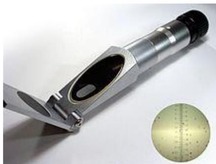
Refractometro manual, dispositivo analogico que mide por refraccion de escala de colores
