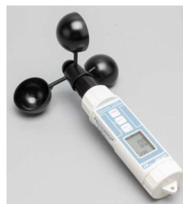
El anemómetro de **rotación** está dotado de hélices unidas a un eje central cuyo giro, proporcional a la velocidad del viento, es registrado convenientemente; en los anemómetros magnéticos, dicho giro activa un diminuto generador eléctrico que facilita una medida precisa.
