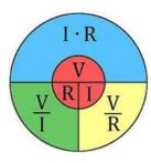
La ley de ohm dice que la intensidad de corriente que atraviesa un circuito es directamente proporcional al voltaje o tensión del mismo e inversamente proporcional a la resistencia que presenta. Siendo la intensidad de corriente medida en amper [A], la tensión medida en volt [V] y la resistencia medida en ohm[ $\Omega$ ].
