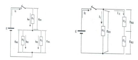
**Resistencia en circuito mixto:** para determinar la resistencia equivalente lo que se hace es descomponer el circuito completo en partes, consistente en circuito serie simple y circuito paralelo simple, resolver cada parte y luego combinarlas.
