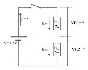
**Ejercicio 2**) Encuentre la intensidad de corriente total, la intensidad de corriente en cada rama, la tensión aplicada en cada resistencia y la potencia total del circuito.
