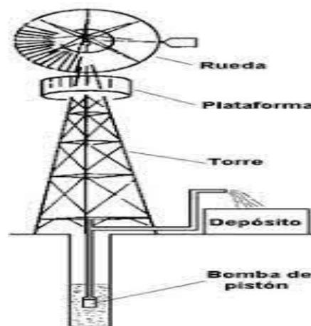
Los molinos son tecnologías de extracción de agua que son accionados a través de la energía eólica (viento). Permiten sacar agua de las perforaciones, pozos, como también de una represa o arroyo. A su vez puede utilizarse para elevar el agua por encima del nivel del suelo o para bombear agua a distancia considerable.
