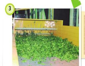
Luego se realiza el secado donde se termina de eliminar la humedad. Este proceso tiene lugar en hornos con cintas transportadoras.
