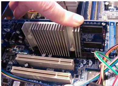
**montada la placa.** Se la coloca de forma que los pines coincidan con el conector y presionamos sin fuerza hasta escuchar el clic que nos indica que ha sido fijada.
