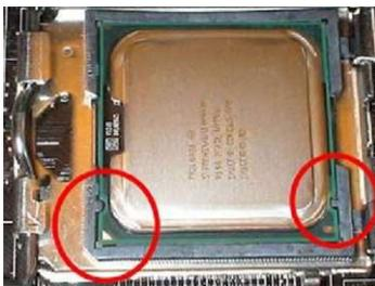
Colocamos con cuidado el procesador sobre el zócalo, **y sin ejercer mucha presión insertamos los pines del procesador en las ranuras del zócalo**. Para ello no debemos hacer fuerza, sólo dejar que el CPU se integre al zócalo. En el caso de que esto no suceda, posiblemente se deba a que el procesador posee alguno de sus pines doblados, el cual podremos enderezar con mucho cuidado con la ayuda de un destornillador plano.
