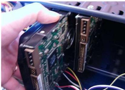
el chasis del gabinete para ello, y una vez bien sujeto con los tornillos adecuados, iniciaremos el conexionado.
