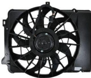
Para poder refrigerar el motor y el radiador se hace uso de un ventilador. El ventilador crea una corriente de aire que pasa, a través del radiador, hacia el motor. El mismo es necesario, cuando el motor se encuentra en ralentí y cuando el aire no es suficiente para refrigerar el líquido refrigerante
