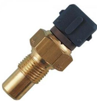
Es un interruptor térmico que por la acción de la temperatura abre o cierra un contacto. Cuando la temperatura del líquido refrigerante va en aumento entonces el interruptor cierra el contacto, de esta manera envía la corriente hacia el ventilador. Este se pone en funcionamiento hasta bajar la temperatura del líquido, otra vez actúa el termo contacto y abre el circuito, deteniendo al ventilador.
