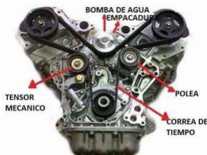
Las poleas son ruedas conductoras, o conducidas, encargadas de accionar un accesorio del motor, también son las encargadas de transmitir el movimiento entre poleas.
