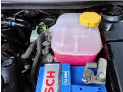
El depósito de expansión es el encargado de recoger el vapor del líquido refrigerante y condensarlo, cuando el motor está en funcionamiento y comienza a levantar temperatura normal de funcionamiento, entonces el líquido alcanza cierta presión y se evapora.
