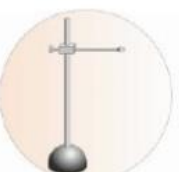
Soporte universal Aparato con un sistema de pinzas que sirve para sujetar tubos de ensayo y otros materiales.
