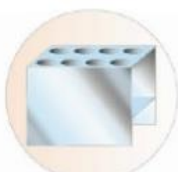
Gradilla Artículo utilizado para mantener verticales los tubos de ensayo.
