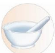
Mortero Vaso en el que se machacan sustancias con un instrumento rígido llamado mano.
