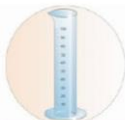
Probeta Tubo graduado con pie destinado a medir líquidos.
