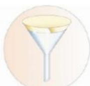
Embudo Útil en forma de cono terminado en una caña usado para trasladar líquidos.
