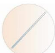
Agitador Varilla de vidrio usada para remover líquidos.
