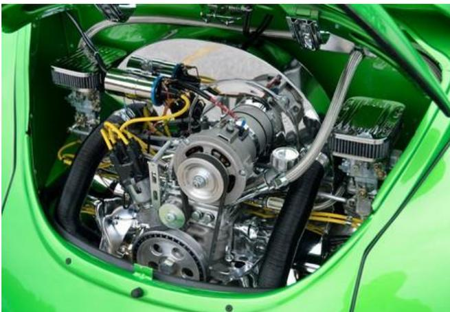
El carburador es en realidad una pieza muy sencilla en concepto. Tiene una entrada de aire superior por donde entra... el aire, y a la mitad tiene una entrada de gasolina que se va almacenando en un contenedor aparte. Este contenedor funciona con un flotador que cuando la gasolina baja de cierto nivel abre una válvula que deja entrar más combustible para volverla a cerrar cuando el flotador llega a cierto nivel.
