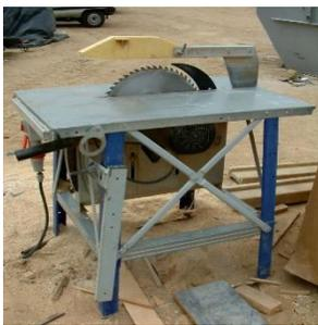
La **sierra circular** es una máquina para aserrar longitudinal o transversalmente madera, metal, plástico u otros materiales. Está dotada de un motor eléctrico que hace girar a gran velocidad una hoja circular. Se caracterizan por realizar cortes precisos.
