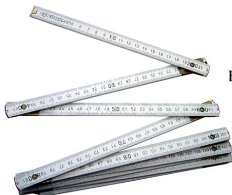
El **metro plegable, metro de carpintero o metro de albañil** es un instrumento de medida de precisión media, que se utiliza en la construcción, carpintería y bricolaje. Entra en el grupo de medir y marcar. Puede ser de madera, color amarillo y consta de 5 pares abisagradas cada 20 cm con numeración a ambos lados de él.
