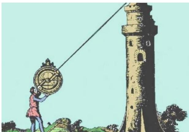
recurrir a conceptos de trigonometría, específicamente aquellos relacionados con la resolución de triángulos rectángulos. En general, en situaciones en las cuales por razones de inaccesibilidad no es posible medir un objeto directamente, se recurre a conceptos de trigonometría.
