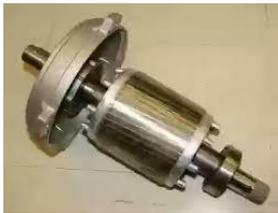
❖ Motores de rotor en jaula de ardilla (o motores con inducido en cortocircuito)
