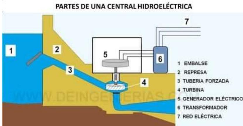
Se frena el agua en un embalse y, se canaliza por una tubería para que haga girar una turbina que moverá el generador, transformando la energía cinética del agua en energía eléctrica
