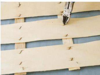
5) CON UN DESTORNILLADOR, LEVANTAR LAS PUNTAS DE LAS GRAMPAS Y SACAR CON UNA TENAZA.
