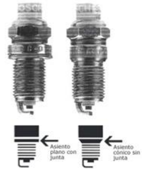
Tipos de asiento de estanqueidad de las bujías
