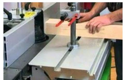
**Precauciones.** Al cambiar el disco se debe verificar que la maquina esta desconectada de la corriente eléctrica. No tocar las partes que se encuentren en movimiento ya que pueden ocasionar accidentes. Mantener siempre actitud de alerta al utilizar el trompo tomando sus debidas precauciones. Mantener la pieza
