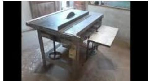
Partes de una sierra de banco. Cubierta. Corredera. Disco de acero con dientes de tuxteno.
