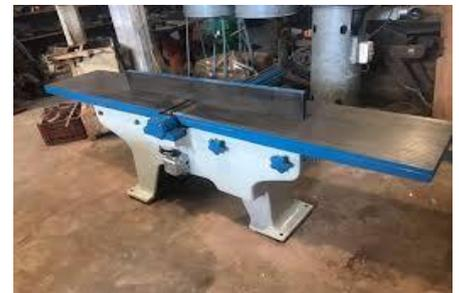
**Precauciones.** Al cambiar el disco se debe verificar que la maquina esta desconectada de la corriente eléctrica. No tocar las partes que se encuentren en movimiento ya que pueden ocasionar accidentes. Mantener siempre actitud de alerta al cantear tomando sus debidas precauciones. Mantener la pieza completamente fija a la corredera. Usar permanentemente el equipo de seguridad. No rebajar ningún otro material que no sea madera. Mantener siempre la maquina limpia.
