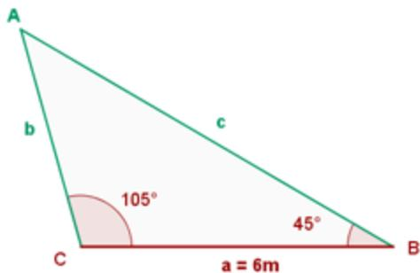
$$A = 180^\circ - 45^\circ - 105^\circ = 30^\circ$$
