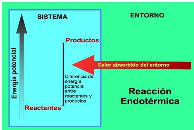
Diagrama de energía de una reacción endotérmica general.
