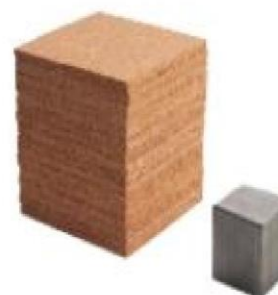
Ambos bloques tienen la misma masa, 1 kg, pero el acero es mucho más denso que el corcho. Por eso el bloque de acero es más pequeño.
