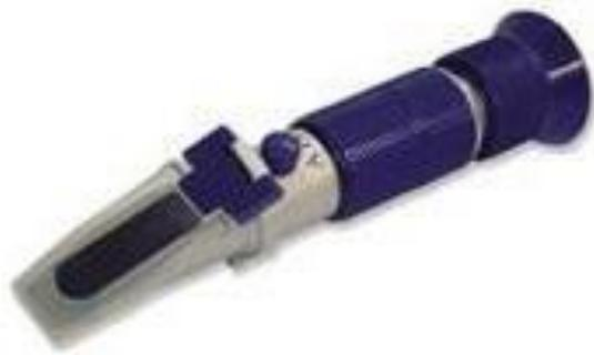
Para medir los índices de refracción del jugo de las frutas sobre el terreno existen refractómetros portátiles.
