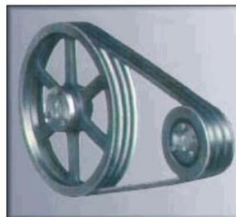
Una banda de transmisión sencilla, por lo tanto, se trata de un sistema de dos ruedas y dos ejes. La polea que se conecta a la fuente de potencia recibe el nombre de polea transmisora o motriz (motor, manivela, etc.). La otra polea se denomina receptora. En casi todos los casos ambas poleas giran en el mismo sentido. Si la banda se tuerce y se cruza las poleas girarán en sentidos opuestos, configuración no apropiada para las aplicaciones a alta velocidad, debido a la gran generación de calor.
