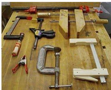
Esta herramienta se denomina **sargento** o prensa, es una herramienta manual de uso común en profesiones como carpintería o herrería, se compone por dos mordazas, regulables con un tornillo que al girar en uno de los extremos ejerce presión sobre la pieza colocada entre dichas mordazas.
