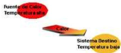
Esa cantidad de energía que se transfiere de un cuerpo a otro por diferencia de temperaturas se llama **calor**.
