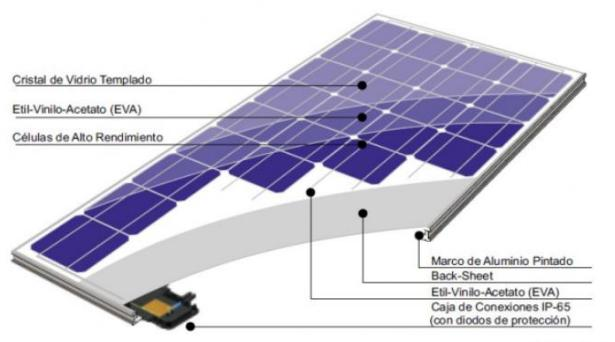
Componente de un panel fotovoltaico
