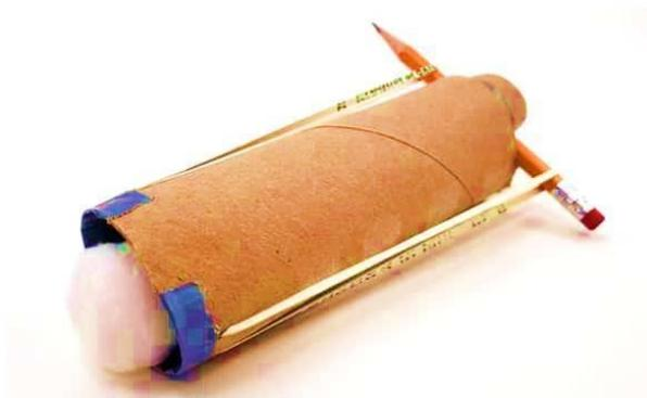
En este experimento de energía has usado dos tipos de energía para cargar y lanzar la bolita de algodón. Cuanto más tensas el lápiz más energía potencial almacena la bolita de algodón. Al soltar el lanzador la energía potencial se convierte en cinética que impulsa la bolita a salir volando por los aires.
