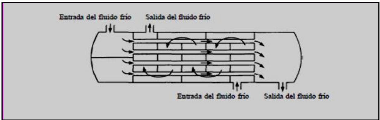
FIGURA 4.9-2. Intercambiadores de calor de tubos y coraza: a) un paso por la coraza y un paso por los tubos,
